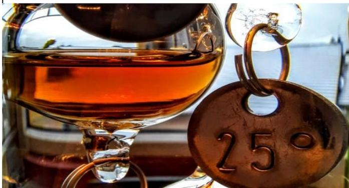
Ein Thermometer nach Galileo Galilei, die temperaturabhängige Dichte der Flüssigkeit ist hier das Messkriterium...
